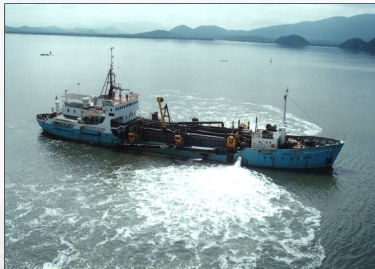
Draga-navio autotransportadora “Recreio dos Bandeirantes” - 1.340 m 3 , construída em 1960.
